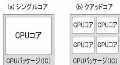
図1 シングルコア CPU とマルチ（クアッド）コア CPU の違い。一つの CPU パッケージに、何個の CPU コアがあるか（シングル＝1個、クアッド＝4個）が異なる。
