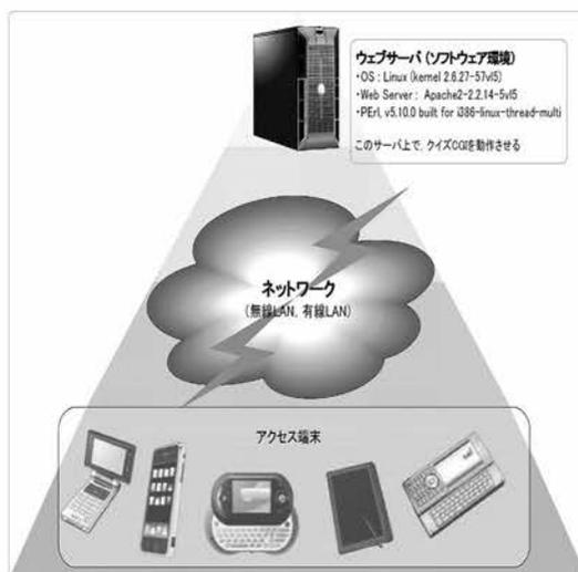
図1 コンテンツ配信システム概念図。Linux OS を用いて構築したウェブサーバ上に学習用コンテンツを構成するクイズ CGI およびデータを配置し、端末に配信する。
