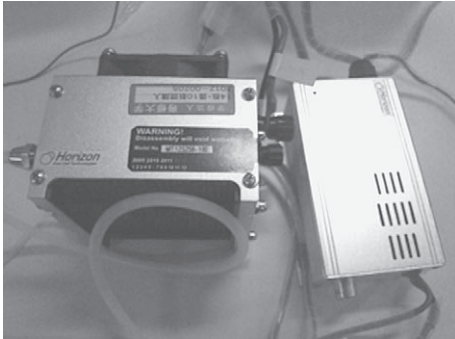
図2 燃料電池本体（左）とガス供給コントロールユニット（H-100 Fuel cell stack system, Horizon Fuel Cell Technologies, Singapore）
