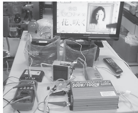
図 5 本研究で作成した緊急用電源の実体写真
