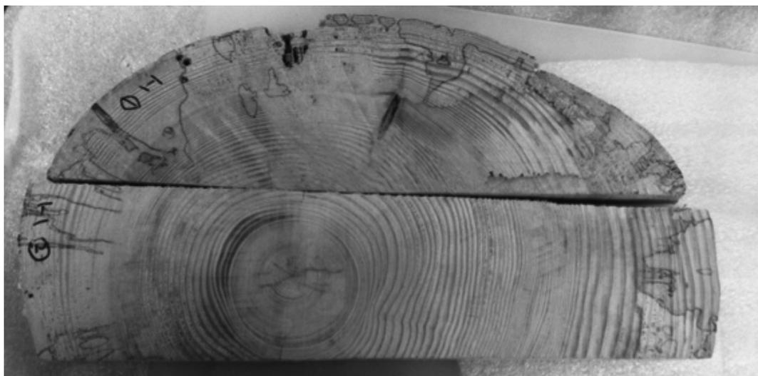
図6 オートラジオグラフィによるイメージ露出を行ったモミ樹幹断面試料
