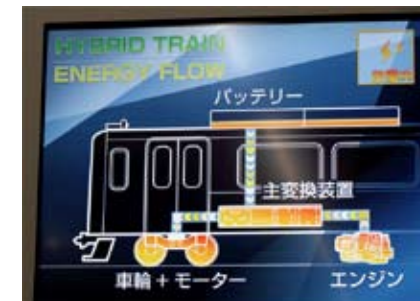
加速時(バッテリーとエンジンの両方でモーターを駆動)
