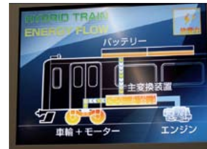
発車時(バッテリーによりモーターを駆動)
