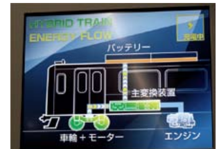
減速時(回生ブレーキによりバッテリーに充電)
