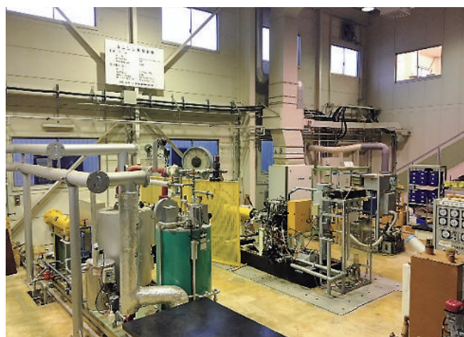
ボイラー、エンジン性能試験機
