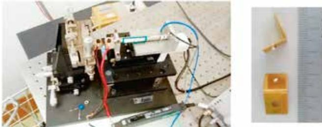
図6 実験装置(圧電アクチュエータ、6軸ゴニオメータ)と 半球電極・円盤電極
