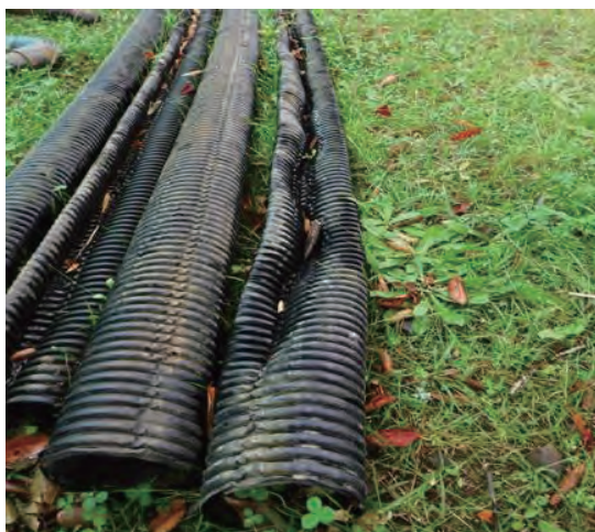
写真 2-5 大学水槽実験でフラッシュ洗浄時に取り出した水槽底部埋設集水管（ポンプ負荷変動により変形している）
