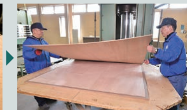
天板の表と裏に単板の積層材を貼りあわせて、プレス機で圧力を加えます
