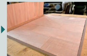
天板の大きさに合わせた額縁の中に小割りにした積層材を埋めていきます
