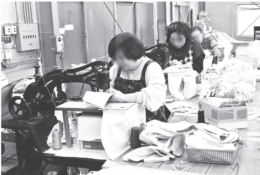
写真2 ドイツ製ミシンを使用する足袋の工程（その1）
