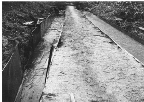
写真2 鉄穴流し (左右交互に使う) (千種)
