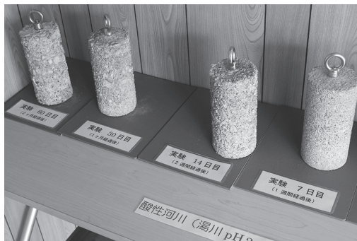
写真 2-3 「湯水の謎小屋」展示（環境体験アミューズメント（学習広報施設）：酸性河川で溶けるコンクリート
