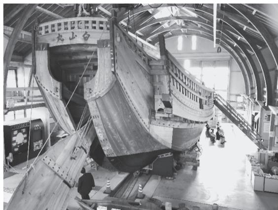
写真5：板図から再現された北前船“白山丸”を舵のある船尾から
