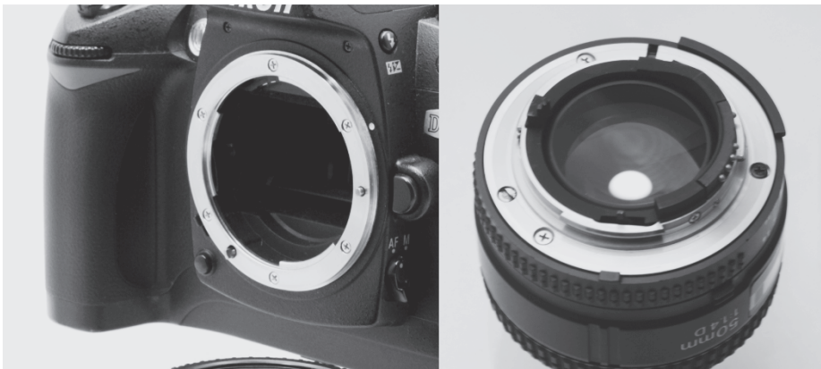
図2 バヨネット式のマウント ボディ側に内爪 レンズ側に外爪をもつ
