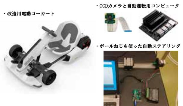
図 9. 自動ステアリング電動ゴーカート
